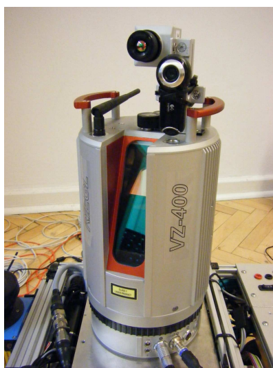
Slika 2.2: Senzorski sistem sa 3D laserom, termalnom i RGB kamerom
